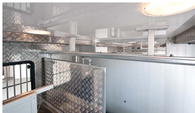
Schiebewände vor den Pferdeköpfen, mit freiem Deckenbereich für Luftzirkulation Sliding walls in front of the horses' heads, with headroom for free air circulation
