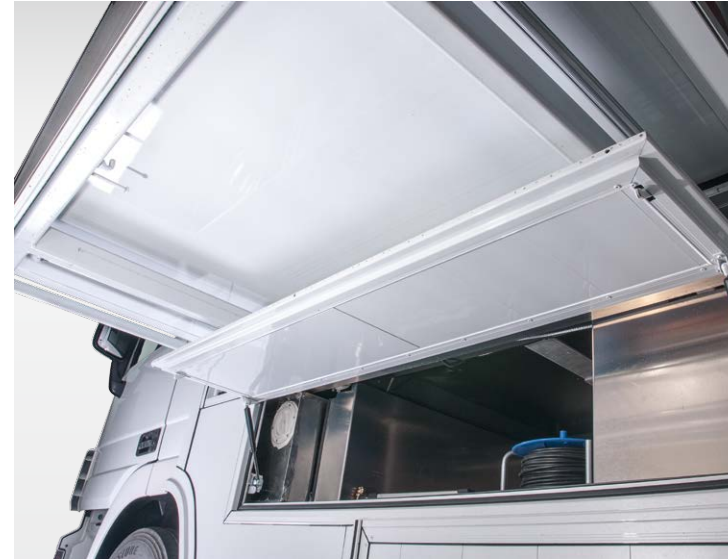
Pop-Out von unten mit zwei Hydraulikstempeln und zusätzlichem Stauraum Pop-out from below with two hydraulic struts and additional storage space
