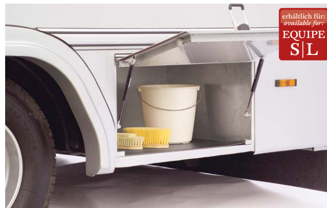
Staufach klein , mit Aufstellklappe, Unterflur Small compartment , with hinged flap, underfloor
