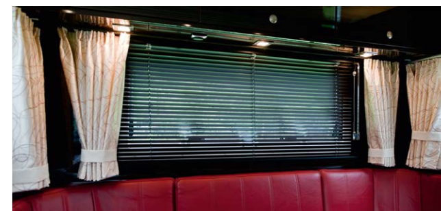
Fenster , aufstellbar, isoliert mit Fliegengitter, Sonnenschutzrollo, Vorhänge und Jalousie Hinged windows, insulated, with fly netting and roller blind, curtains and venetian blind
