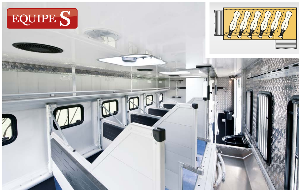
Schrägstellung (L-Trennwände inklusive Kopfstück, mit seitlicher Sattelkammer) Slant position (L-partition including head section, with tack room at side)
